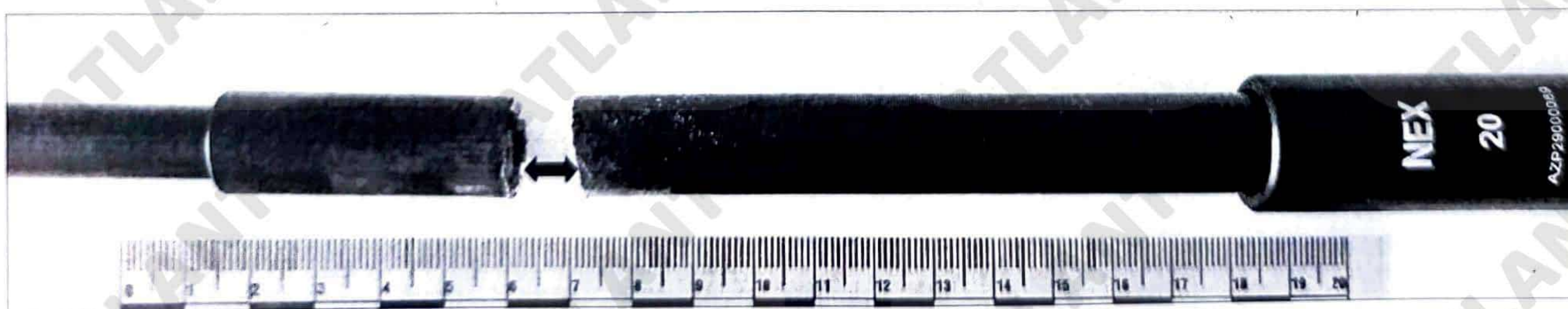
Зображення 5. Остаточна деформація після експертних експериментів.
